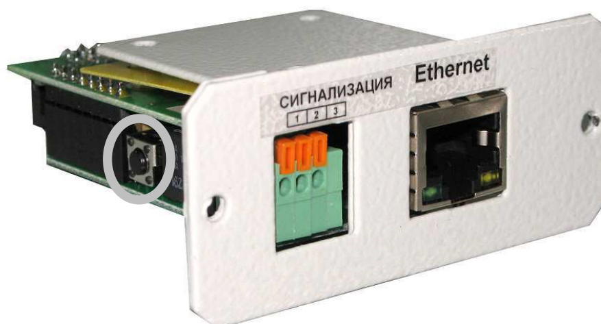
Рисунок 2.1 – Кнопка перезагрузки изделия и возвращения стандартных настроек
